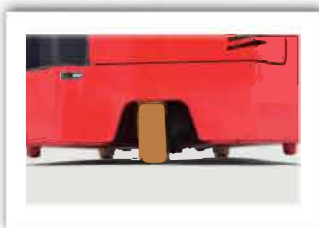
Устойчивость благодаря конструкции с 3 точками опоры при повороте.
